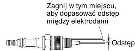
Rysunek 15 - Odstęp między elektrodami świecy zapłonowej, modele 20kW, 29kW, 44kW
