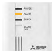
Błąd (czujnika, połączenia)
